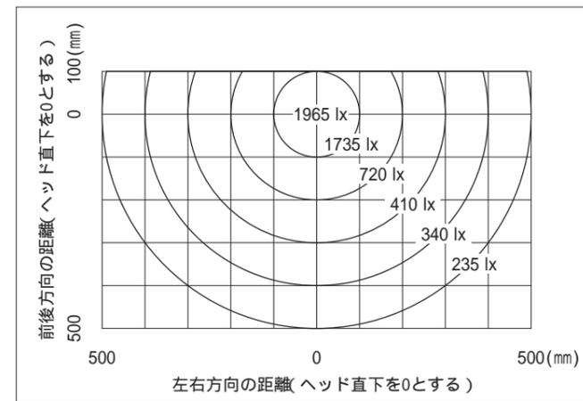
ヘッド高さ380mm、調光強の時の机上面照度
