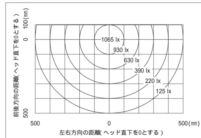
ヘッド高さ380mm、調光中の時の机上面照度
